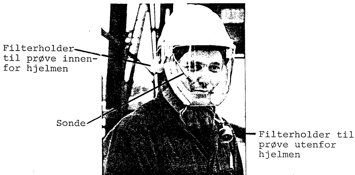
Figur 2.1 Påmontering av personlig prøvetakingsutstyr for prøvetaking innenfor og utenfor luftrensehjelm.
