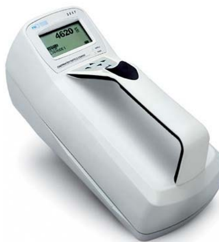
Fig. 1: Prinsippskisse og foto av TSI bærbar kondensasjon kjerneteller (kilde: www.TSI.com )
