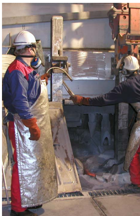
Fig. 12: Prøvetaking ved anodeskift i Prebakehallen (Foto: P. A. Drabløs, Hydro Karmøy)
