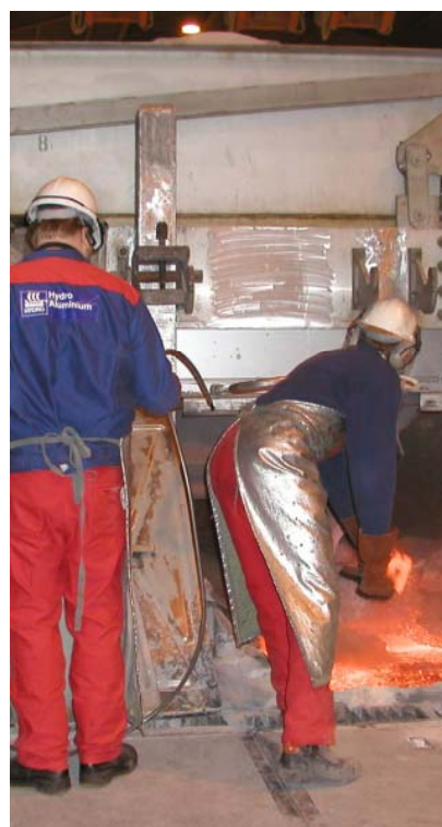
Fig. 12: Prøvetaking ved anodeskift i Prebakehallen (Foto: P. A. Drabløs, Hydro Karmøy)
