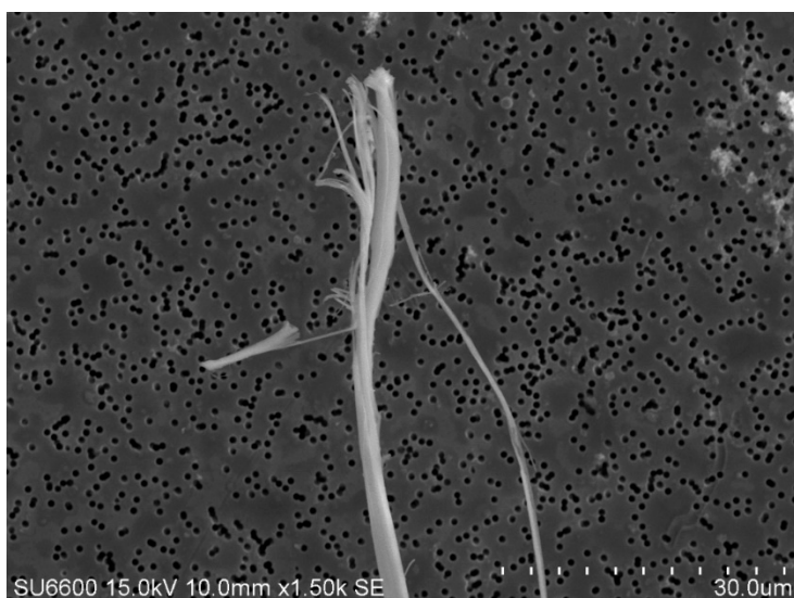
Figur 4.7: krysotilfiber samlet opp med luftprøvetaker under en pågående brann (Foto: Torunn K. Ervik, STAMI)
