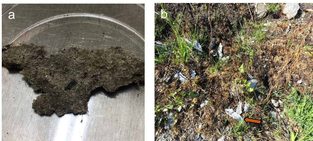
Figur 4.5: Materialprøve (a) av veggplate funnet i nærhet til et brannsted (markert med en pil) (b) (Foto: Torunn K. Ervik og Pål Graff, STAMI).
