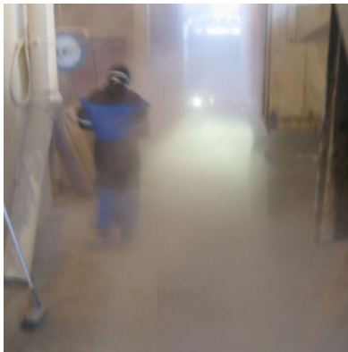
Støv i tippesonen i kornmottaket
