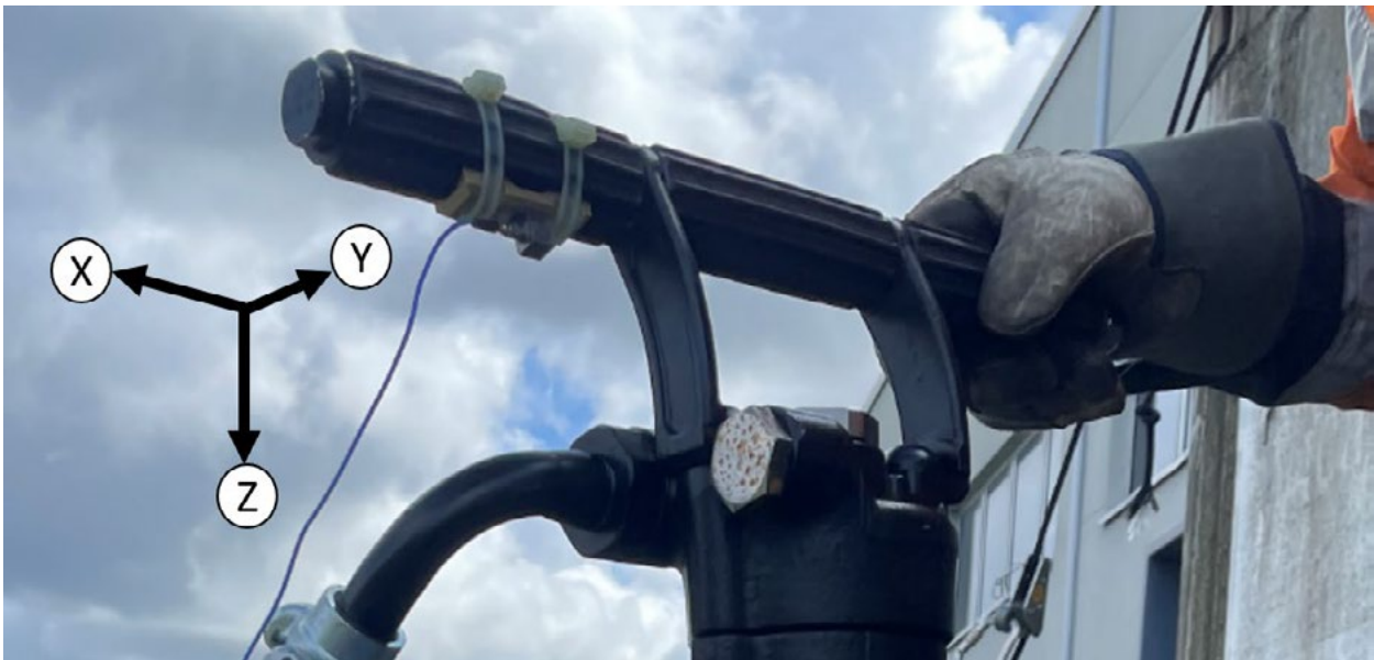
Figur 1: Accelerometerplacering på handtaget.
