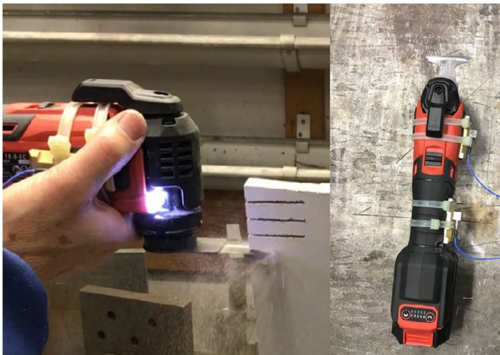
Figur 6: Vänster: Mätförhållandet vid sågning i spånskiva med multicutter. Höger: Accelerometerplacering.
