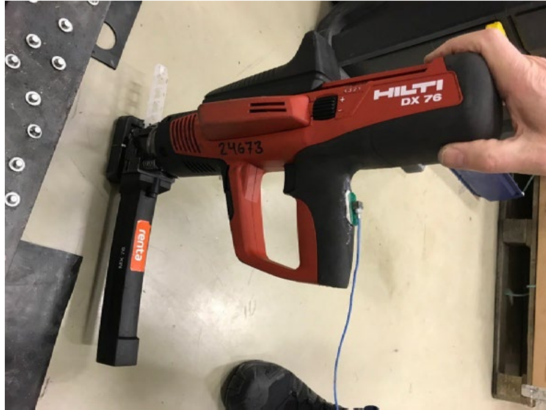
Figur 7: Accelerometerplacering på Hilti DX 76 bultpistol.
