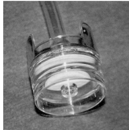
Bilde 2: 37 mm klar kassett ("millipore" kassetten).
